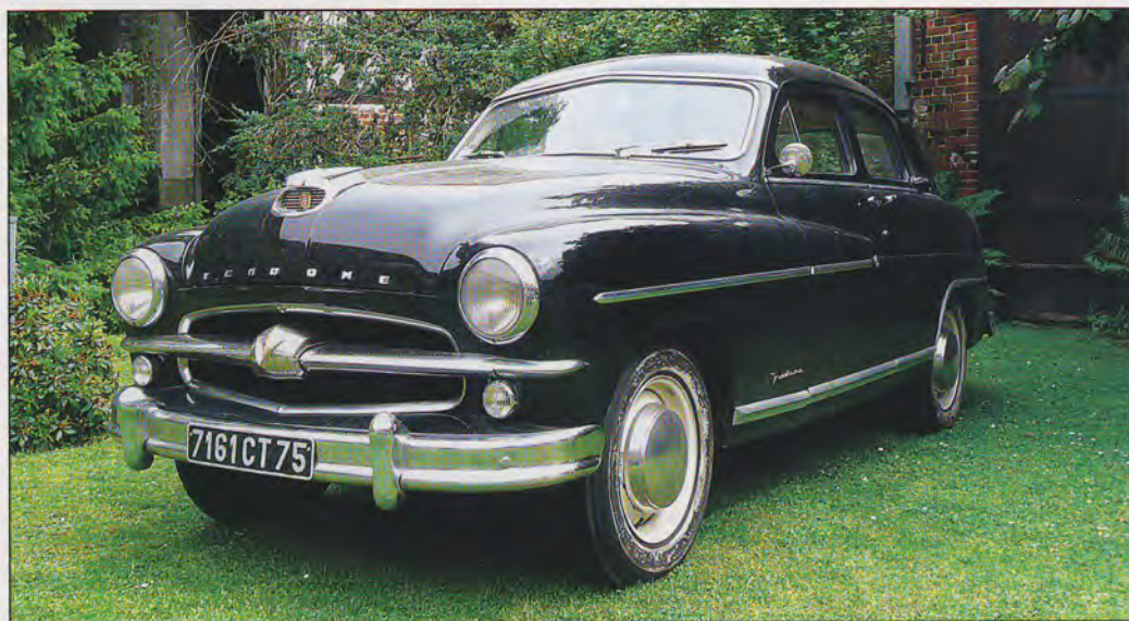
Extrapolation de la Vedette, la version Vendôme de 1953 est animée par un moteur V8 Mistral de 3,9 litres à soupapes latérales, d'une puissance de 22 CV. Sa vitesse maximum frise les 150 km/h, ses accélérations sont spectaculaires, elle est puissante et silencieuse. Malgré ces séduisantes performances, elle pêche par sa consommation excessive à grande vitesse, ses freins qui ont tendance à chauffer et sa maniabilité qui se trouve gênée par le poids de son train avant. Elle ne sera fabriquée qu'à environ trois mille exemplaires.
